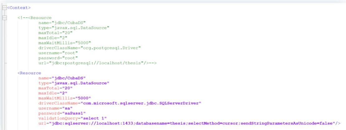
Рисунок 16. Настройка подключения к БД
